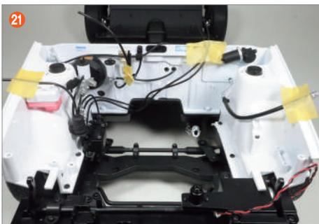
21 在將引擎安裝到底盤之前，可以用膠帶等將各個配線暫時固定，這樣會使作業更容易。請注意暫時固定時不要讓已經安裝好的配線脫落。
