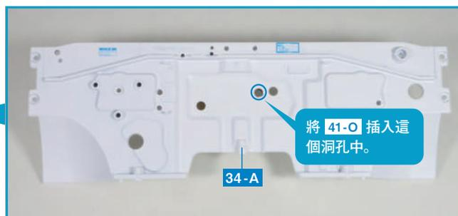
24 將在步驟 23 中安裝的 41-O 插入艙壁隔板 34-A 的洞孔中，然後將引擎從後方 (變速箱) 側插入前懸吊結構 4-A 和車身淺盤型地板 19-A 之間。
