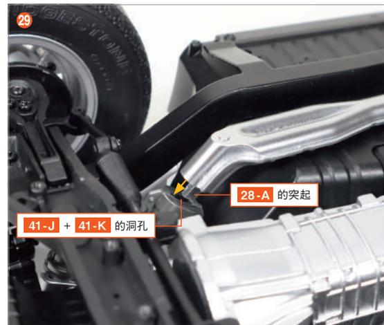
將 28-A 的方形突起部分插入排氣前管上部 (41-J + 41-K) 的方形孔中。
