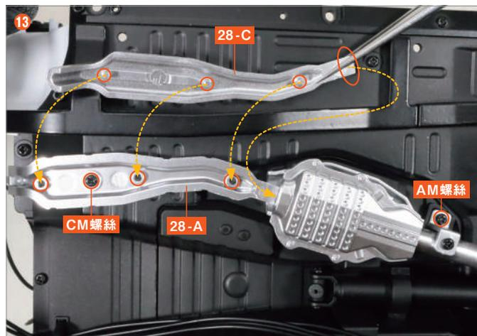
重新使用步驟 10 拆下的 AM 螺絲 和 CM 螺絲，將其再次鎖緊，將 28-C 背面的 3 個突起部分對準 28-A 的 3 個洞孔，並將其嵌入。
