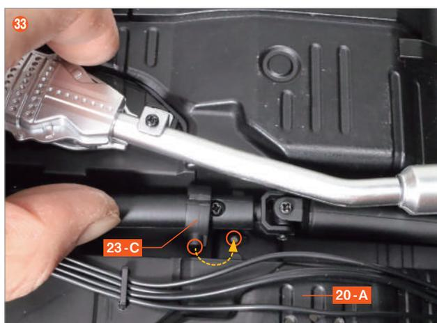
將中心支撐軸承 23-C 的螺絲孔突起部分與 20-A 的凹槽對齊嵌入。
