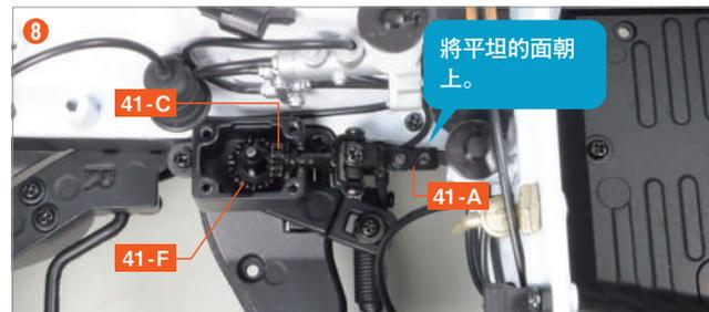
將前輪對準直行方向, 並保持不動, 將 41-C 和 41-F 的齒輪咬合並組裝。在此過程中, 將 41-A 的兩個螺絲孔面中的平坦面朝上。
