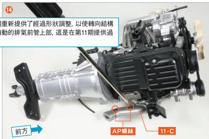
將引擎翻轉，拆下排氣前管上部 (1) 11-C 上的兩根 AP 螺絲。如果難以拆卸，建議使用 0 號十字螺絲起子。請妥善保管拆下的螺絲，因為稍後還需再次使用。
