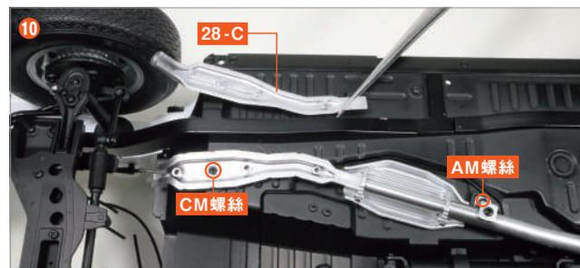
將整個底盤翻轉過來, 拆下排氣管前段(2) 28-C, 然後卸下 圈起的 AM 螺絲 和 CM 螺絲。因為這些卸下的螺絲稍後還會再次使用, 所以請妥善保管。
